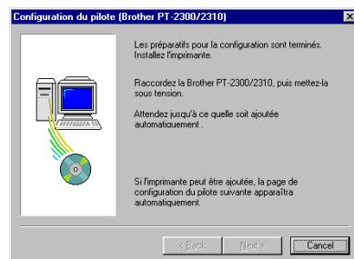
Raccordez la PT-2300/2310 à l'ordinateur à l'aide du câble d'interface USB comme décrit à la page 6, puis mettez la PT-2300/2310 sous tension. Une boîte de dialogue apparaît pour vous indiquer que le pilote d'imprimante est installé.
